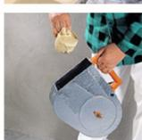
Charger l'équivalent de 2 grosses louches d'enduit maximum. Recharger au fur et à mesure.
