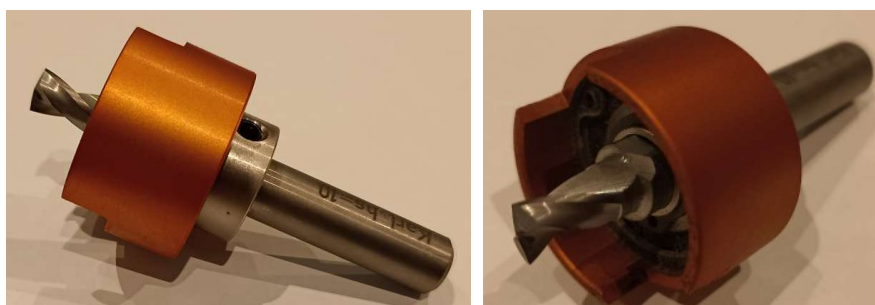
Figura 2.2.18 –Broca com batente do sistema KARL
