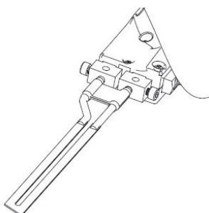
1. Desserrez les vis de la matrice de blocage de lame avec la clé.
