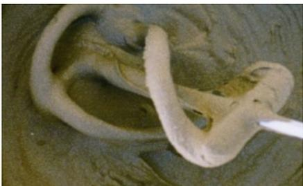
1. Mélanger chaque kg de poudre avec environ 0,4 L d'eau propre. Mélanger, de préférence mécaniquement avec un malaxeur à basse vitesse jusqu'à obtention d'une masse homogène sans grumeaux.
